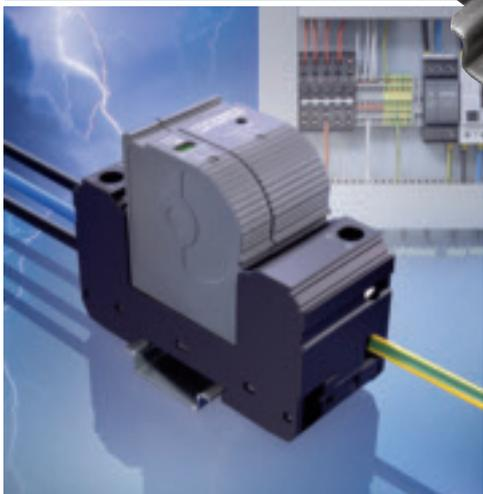
VAL-CP-TOV сочетает в себе функции устройства защиты от импульсных перенапряжений класса II и возможность индикации повышенного рабочего напряжения. Если напряжение станет выше допустимого, то цепь питания потребителя будет отключена.
