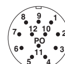
Расположение контактов разъема M23, 12-полюсн.
