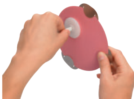
Обработать конец оптоволоконка
