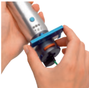
Выполнить скол и отломить оптоволоконно
