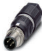
Вилка M12, прямая, для проводников сечением: 0,34 мм 2 ... 0,75 мм 2
