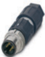
Вилка M12, прямая, для проводников сечением: 0,14 мм 2 ... 0,34 мм 2
