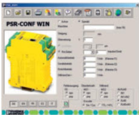
Реле скорости вращения PSR-RSM4, после подсоединения по протоколу последовательной передачи данных, может быть сконфигурировано с помощью простого в использовании программного обеспечения для ОС Windows.
