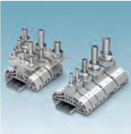
Новое поколение клемм на высокие токи HV обеспечивает даже в очень стесненных условиях надежное подсоединение до 4 проводников с кабельными наконечниками по DIN 46234, 46235 и 46237. Для предотвращения ослабления затяжки шестигранных гаек используются пружинные шайбы. Широкий ассортимент принадлежностей обеспечивает надежное и удобное подсоединение проводников сечением до 120 мм<sup>2</sup>.
