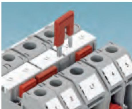
С помощью перемычек переходного сечения можно легко соединять клеммы с разным номинальным сечением, например, RT 8 и RT 3. Использование перемычек переходного сечения позволяет без труда реализовать схемы ввода электропитания.
