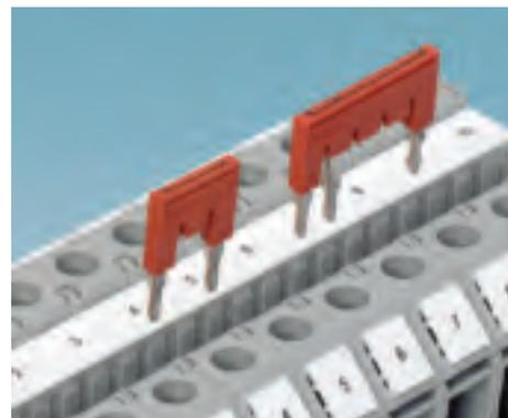
Для соединения несмежных клемм используют стандартные перемычки, у которых удалены отдельные выводы. Таким образом можно для двух цепей объединить клеммы, расположенные в разных местах группы. Все точки соединения могут быть дополнительно промаркированы.
