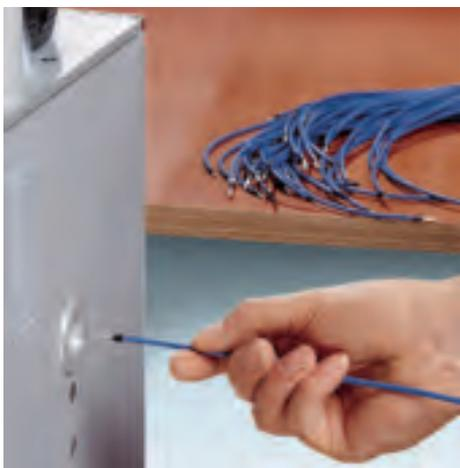
Автомат для снятия изоляции и обжима CF 1000 применяется для обработки поставляемых россыпью кабельных наконечников с изолирующими втулками согласно DIN 46228-4. Производительность автомата составляет: до 1200 обработанных проводников в час. Автомат осуществляет снятие изоляции с проводника и обжим его кабельным наконечником. Обеспечиваемое усилие вырыва соответствует требованиям МЭК/EN 60999 и МЭК/EN 60947.
