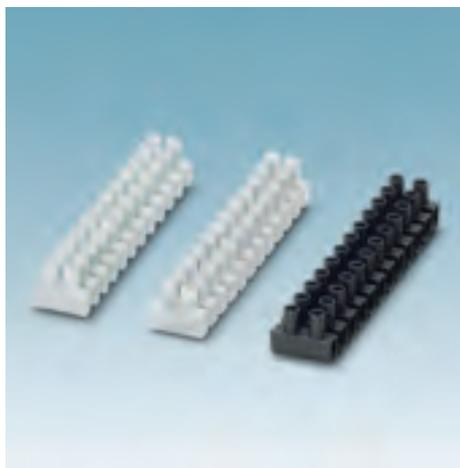
Евроклеммы EC... P TR для проводников сечением до 16 мм<sup>2</sup> оснащаются приспособлениями для защиты проводников и могут применяться также для присоединения тонкопроволочных проводов в том числе без кабельных наконечников. Изолированный корпус изготовлен из несодержащего галогенов полиамида (PA). Высококачественные металлические части с коррозионнстойкими поверхностями прочно зафиксированы на корпусе клеммы.
