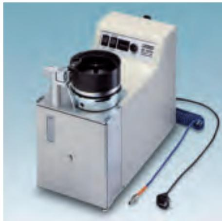
Автомат для снятия изоляции и обжима CF 1000 предназначен для установки гильз с изоляцией (поставляются россыпью) согласно DIN 46228-4. Данный автомат способен за один рабочий проход снять изоляцию с кабеля и установить гильзу.
