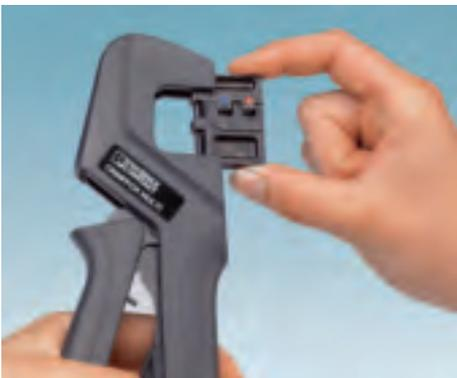
Универсальные обжимные клещи CRIMPFOX-M оснащены сменной матрицей и предназначены для обработки контактов всех типов. Замена матрицы выполняется легко и быстро без использования дополнительного инструмента.
