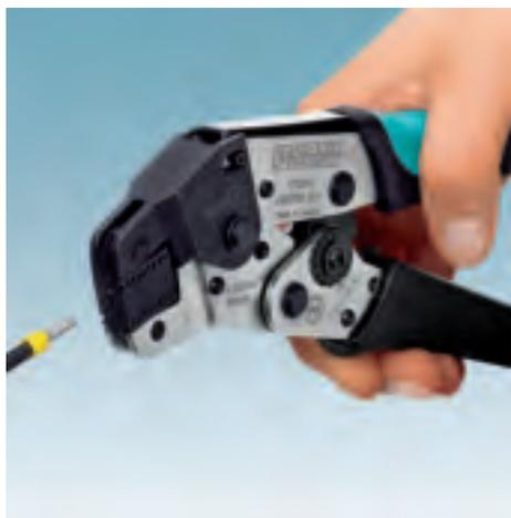
Клеши для опрессовки CRIMPFOX обеспечивают оптимальный обжим кабельных наконечников любого типа даже для проводников большого сечения, при этом при работе требуется минимум физических усилий. Благодаря функции принудительной блокировки (с возможностью отмены) клещи гарантируют неизменно высокое качество обжима. Промаркированные матрицы обеспечивают точную обработку в соответствующем диапазоне сечений.
