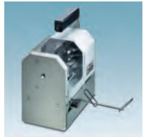
Автомат для снятия изоляции и обжима CF 3000-2,5 предназначен для установки гильз с изоляцией (поставляемых в виде ленты) на многожильные кабели согласно DIN 46228-4. Данное устройство способно за один рабочий проход снимать изоляцию и устанавливать гильзы на кабели сечением от 0,25 до 2,5 мм<sup>2</sup>. Настройка прибора на другое сечение проводника выполняется в течение минуты.
