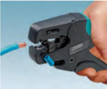
С помощью инструмента для снятия изоляции можно быстро, точно и надежно обрабатывать кабели и проводники любых типов. Настройка инструмента на сечение проводника выполняется автоматически.
