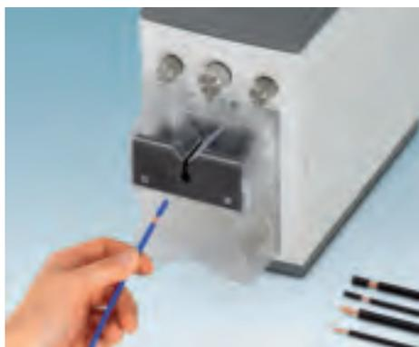
Автоматическое снятие изоляции
