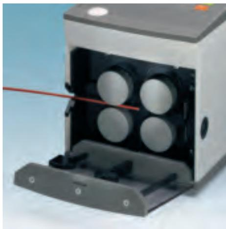
Автоматический резак CUTFOX 10 обеспечивает нарезку проводов, кабелей и профилей. Требуемая длина нарезки и количество отрезков удобно задаются и отображаются на дисплее CUTFOX 10.
