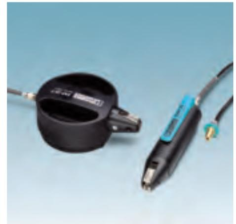
Пневматическое обжимное устройство ZAP предназначено для кабельных наконечников сечением от 0,25 до 10 мм<sup>2</sup>. Включение и отключение устройств производится с помощью клапана с ножным приводом. В каждом инструменте предусмотрено по два отделения для хранения кабельных наконечников.
