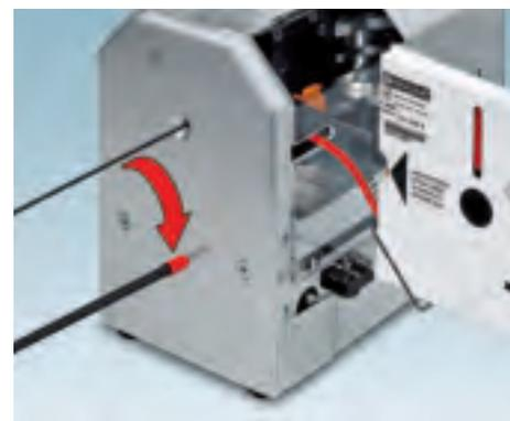
Автоматическое снятие изоляции и обжим за один рабочий проход
