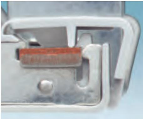
В зону контакта также можно легко и надежно установить общую шину нейтрали размером 3 x 10 мм. При этом электрический контакт шины с заземленной оболочкой комплектного устройства устанавливается автоматически.
