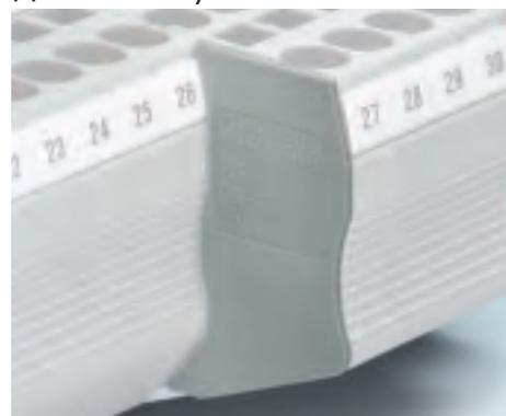
Если в клеммном блоке рядом с двухвыводной клеммой располагается клемма с тремя или четырьмя выводами, то выступающая часть многвыводной клеммы закрывается специальной торцевой крышкой. Таким способом обеспечивается защита от прикосновений.
