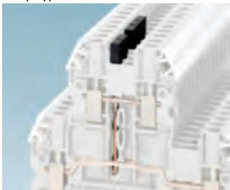
Перемычки для соединения верхнего и нижнего ярусов двухъярусной клеммы. Перемычка устанавливается в гнездо верхнего ряда шунтирования и соединяет его с гнездом нижнего яруса.
