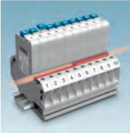
Автоматические выключатели с теплоэлектромагнитными расцепителями UT 6-TMC отличаются компактной конструкцией, наличием больших площадок для маркировки и двух рядов гнезд для установки штекерных перемычек. Наличие гнезд для установки перемычек позволяет легко объединять эти выключатели с остальными компонентами серии CLIPLINE complete.
