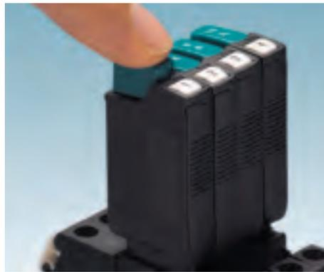
Штекерный автоматический выключатель с тепловым расцепителем ТСП со встроенной функцией ВКЛЮЧЕНИЯ/ОТКЛЮЧЕНИЯ оснащен компактным корпусом и предназначен для цепей с номинальным током от 0,25 до 10 А. Разветвление цепи при этом осуществляется с помощью базовых клемм.
