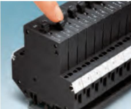
Автоматический выключатель с тепловым и электромагнитным расцепителями ТМС оснащен сигнальным контактом, поставляется в одно-, двух- и трехполюсном исполнении с двумя различными характеристиками срабатывания и предназначается для коммутации цепей с номинальным током от 0,2 до 16 А.
