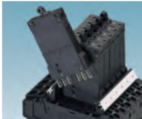
Штекерный автоматический выключатель с тепловым и электромагнитным расцепителями ТМСР может иметь как один, так и несколько сигнальных контактов. Разводка сигнальных проводников и кабелей питания осуществляется с помощью штекерных перемычек.
