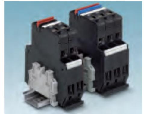
Электронный автоматический выключатель ЕС-Е оснащен сигнальными контактами и, кроме ограничения тока утечки, функций возврата в рабочее состояние, одиночной и групповой сигнализации, предназначается для подключения обратного проводника, ведущего от нагрузки. Контакты могут быть соединены с помощью перемычек.
