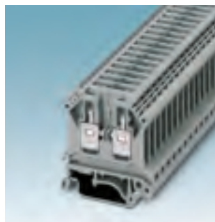
Базовые клеммы для установки штекерных компонентных модулей, штекерных держателей предохранителя и перемычек для оперативной коммутации цепи UK...-TG
