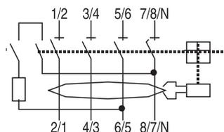
Если в 3-фазной цепи без нейтрали напряжение между фазами находится в пределах 110...254 В, то обеспечить правильную работу кнопки проверки можно двумя способами:
