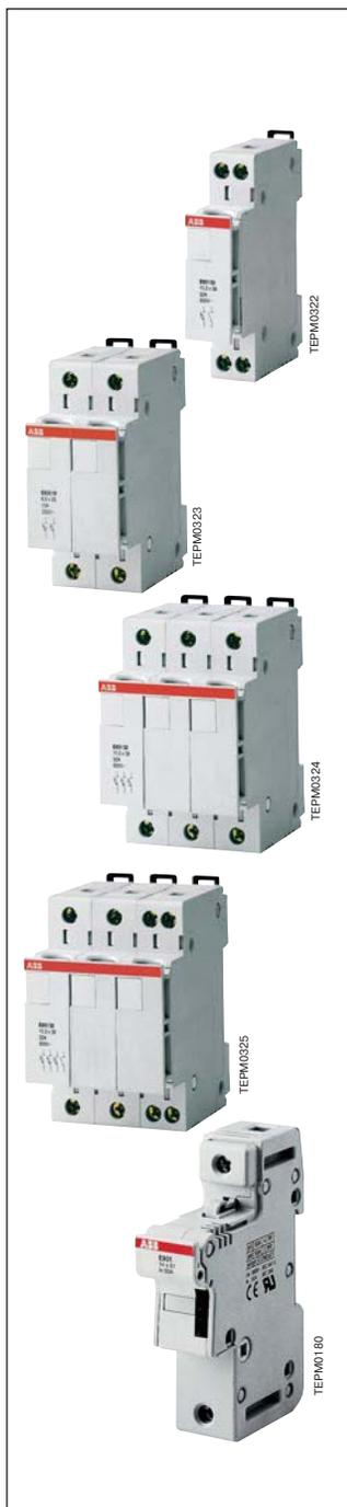
Держатели предохранителей E 930 используются для защиты от перегрузок и короткого замыкания. Они предназначены для использования с предохранителями цилиндрической формы на 20 А, 32 А, 50 А и 125 А.
