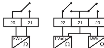
Приборы имеют 2-полюсный сбалансированный и 3-полюсный несбалансированный импульсные выходы для вывода информации в цифровом виде на компьютер. Приборы имеют пассивный выход, и допускают подачу напряжения от внешнего источника
