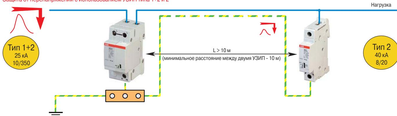
**Защита от перенапряжений с использованием 2 УЗИП типа 2**
