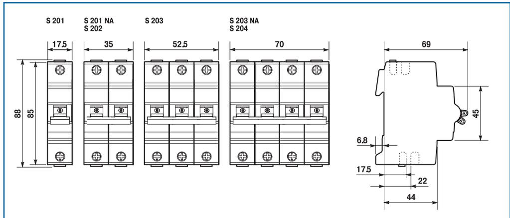
S 200 с вспомогательными контактами, устанавливаемыми снизу
