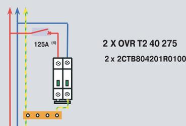
(4) – Максимально допустимое значение (могут устанавливаться предохранители или автоматы, рассчитанные на меньший ток). Обязательно требуется, когда в цепи электропитания не установлен вышестоящий предохранитель или модульный автоматический выключатель.
