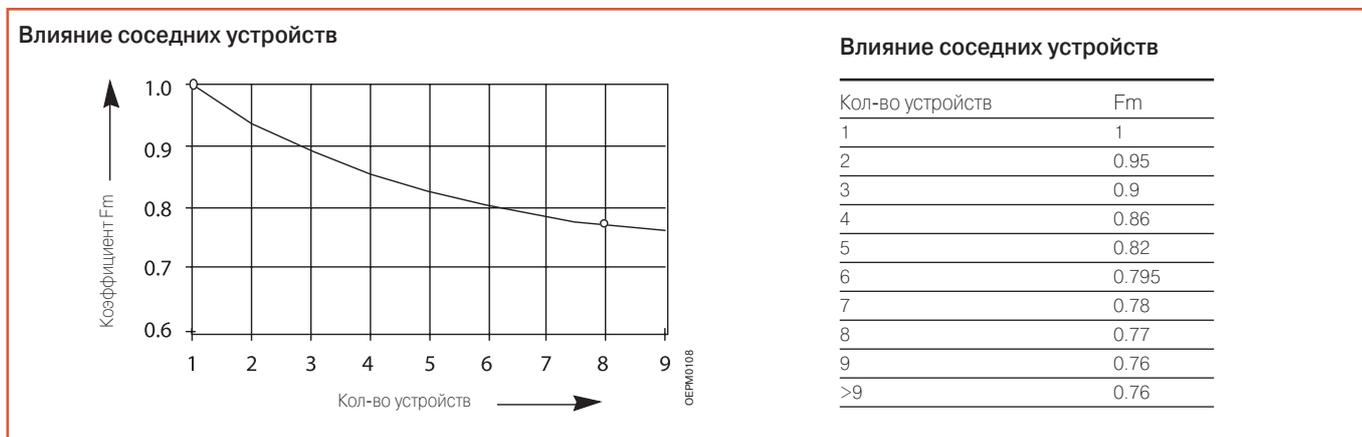
**Пример: Выключатель S 202 C 16 при T= 35 °C**
