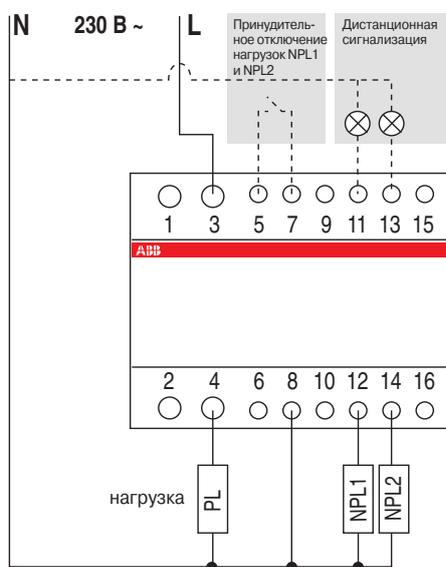
Аппарат должен подключаться после главного автоматического выключателя Принудительное отключение неосновной нагрузки должно выполняться сухим контактом.
