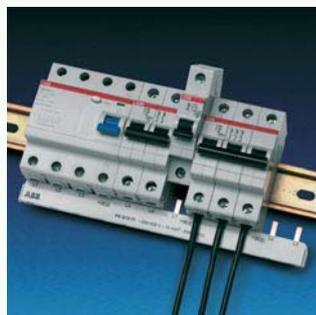
Применение уникальной системы быстрого монтажа позволяет устанавливать и снимать автоматы S 200 или ВДТ F 200 без использования отвертки. Чтобы демонтировать аппарат, просто нажмите на него, снизу вверх.
