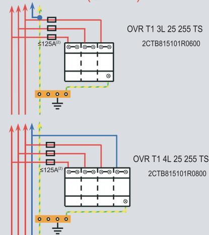
УЗИП OVR T1 устанавливается на вводе ГРЩ,
