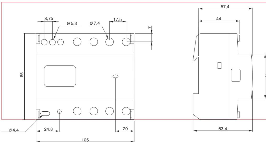
**Электронные трехфазные счетчики электроэнергии DELTA PLUS**
