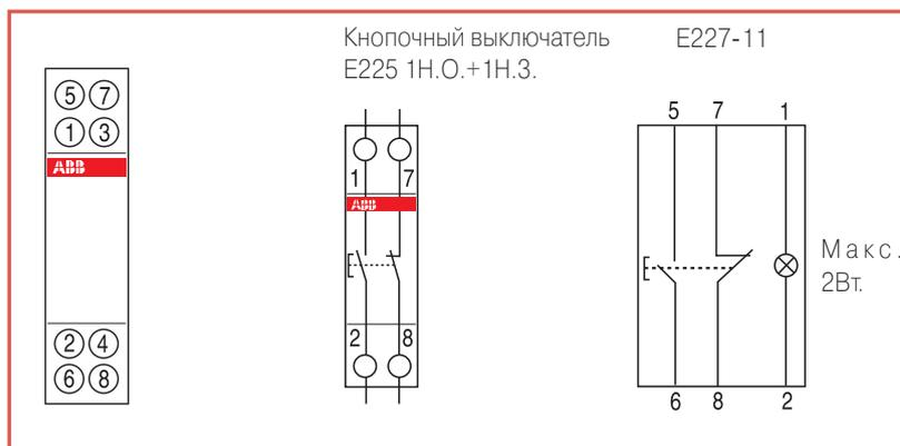
Предназначены для управления нагрузками небольшой мощности, требующими большого количества включений/отключений - автоматика инженерного оборудования зданий, насосы, системы вентиляции, отопления, освещения и т.д.
